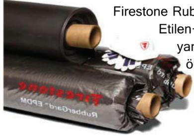
Firestone RubberGard Çatı Sisteminin ana ögesi EPDM membran Etilen-propilen-dien kauçuk ile karbon siyahı yağlar, kür ve üretime yardımcı katkı maddelerinden oluşan tek katlı sentetik kauçuk örtüdür. Kalenderleme yöntemiyle büyük rulolar halinde ve vulkanize edilerek üretilir. İçinde polyester donatılı olan tipi ve yangına dayanıklı tipleride mevcuttur.
